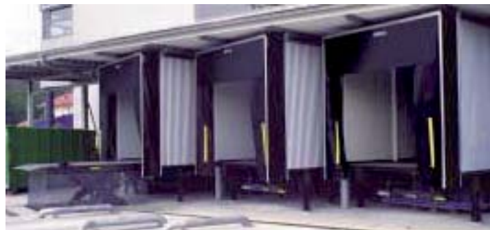
Isolierte Andockstationen mit integrierten Verladeeinheiten
