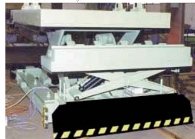
Spezialhubtisch mit elektrischem Fahrwerk
