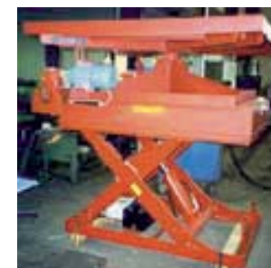
Hebebühne mit elektr. Zusatzplattform
