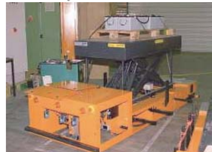
Hebebühne auf einem FTS aufgebaut
